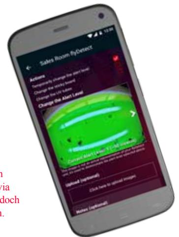
Das aktuelle System ermöglicht fünf verschiedene Einstellungen zur Grenzwertfestlegung bei den Insekten-Fangzahlen (50, 100, 150, 200 und 250 Insekten pro Klebefläche). Die Benachrichtigung via App erfolgt bei Überschreitung des vorher festgelegten Grenzwertes, Bilder der Klebefläche gibt es jedoch bereits ab dem Installationszeitpunkt und unabhängig von der Anzahl der gefangenen Fluginsekten.
